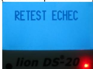
**Dans ce cas**, après un arrêt moteur supérieur à 10 secondes le **véhicule ne pourra plus redémarrer.**
